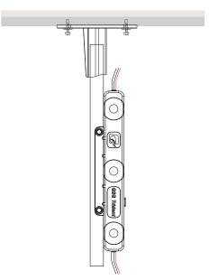
PUT ALUMINUM ROD INTO BRACKET FROM SIDE
